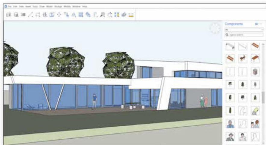
Model koncepcyjny w darmowym BricsCAD Shape. Z prawej strony widoczny jest panel komponentów, natomiast u góry pasek podstawowych narzędzi szkicowania, modelowania i edycji geometrii
