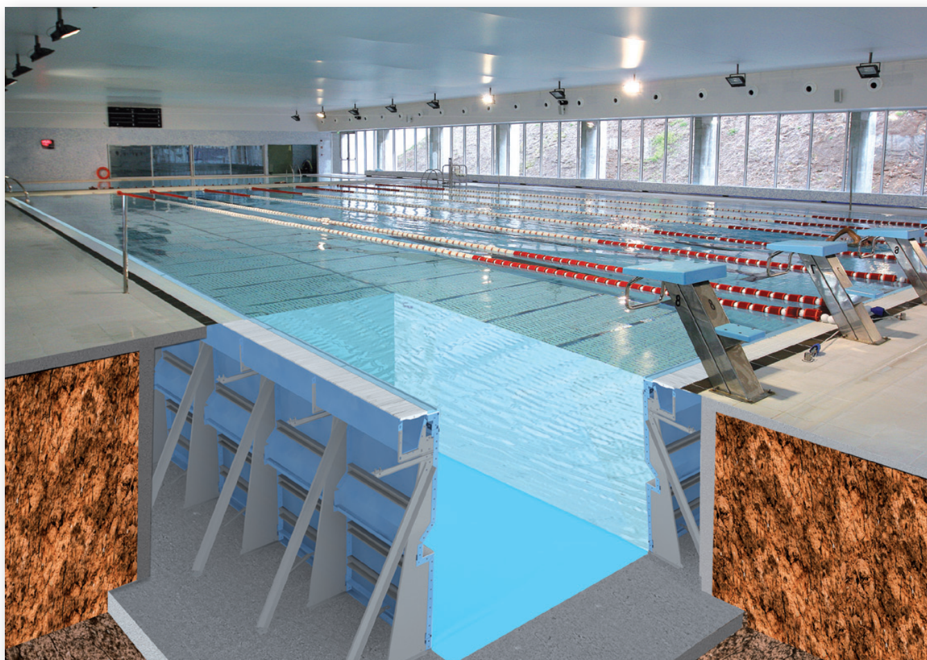
Niecka zbudowana w systemie prefabrykowanych paneli Dynamic Panelpool
