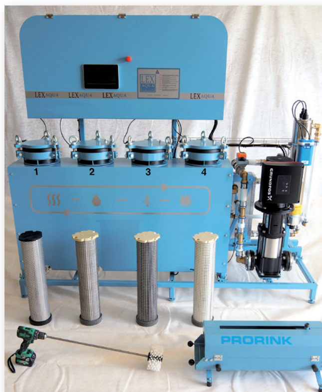
Urządzenie LEX AQUA oczyszcza i dezynfekuje wodę, która powstaje z zebranego przez rolbę lodu. Zapotrzebowanie wody dla lodowiska zmniejsza się o ponad 70%.
