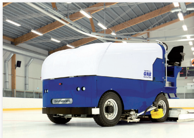
Eksplatacja rolb elektrycznych jest dużo tańsza niż spalinowych. Rolby elektryczne są praktycznie bezawaryjne, a spaliny na lodowisku przechodzą do historii
