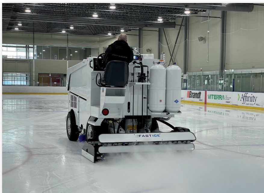
Ciepła woda użyta do odbudowy tafli lepiej wygładza głębokie bruzdy w lodzie i szybciej zamara
