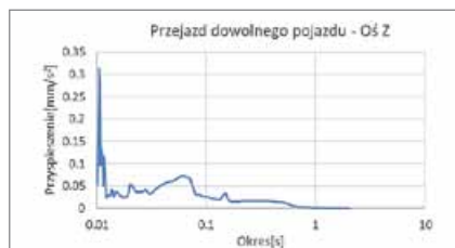
Rys. 3 Wykres zależności przyspieszenia [\text{mm}/\text{s}^2] od okresu [\text{s}] w spektrum odpowiedzi dla przejazdu dowolnego pojazdu – kierunek Z
