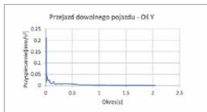
Rys. 2 Wykres zależności przyspieszenia [\text{mm}/\text{s}^2] od okresu [\text{s}] w spektrum odpowiedzi dla przejazdu dowolnego pojazdu – kierunek Y
